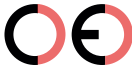
Falsche CE-Kennzeichnung (zu großer Zwischenraum)
