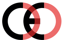
Falsche CE-Kennzeichnung (zu dicht)
